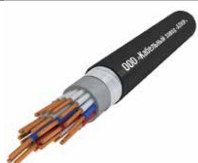
Изоляция из поливинилхлоридного пластика, внутренняя оболочка, броня из стальных оцинкованных лент, защитный шланг из поливинилхлоридного пластика пониженной горючести. | ГОСТ 1508-78<br>ГОСТ 26411-85<br>ТУ 3563-005-41580618-2012 |
